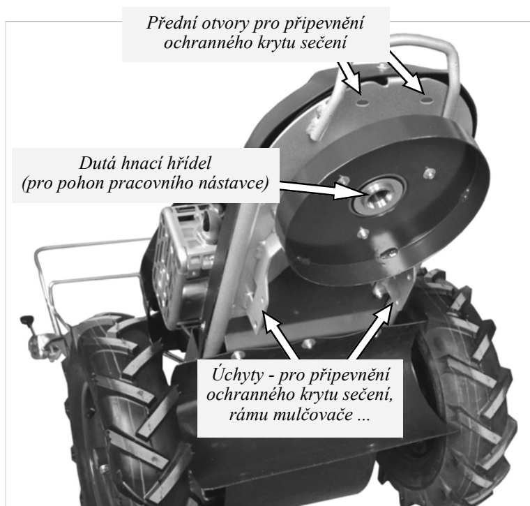
Obr.7 Motorový podvozek Triton - upevňovací prvky pro připojení pracovního nástavce
