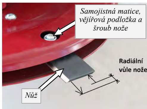
Obr. 48 Detail uchycení nože u STR2 v pohledu shora
