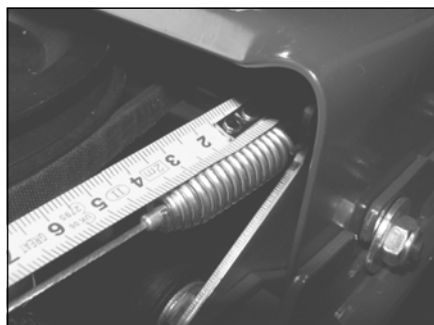
Obr. 63 Měření závitové části pružiny
