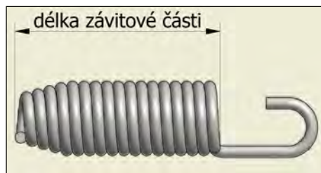
Obr. 64 Délka závitové části pružiny
