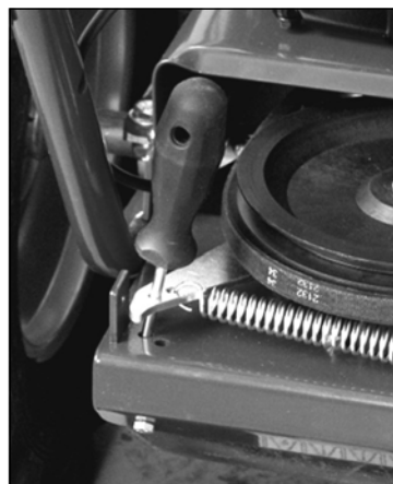
Obr.56 Zajištěná nap. kladka
