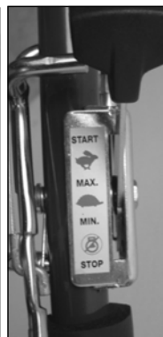
Obr. 9b Plynová páka (se sytičem)
