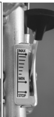
Obr. 9a Plynová páka (bez sytiče)
