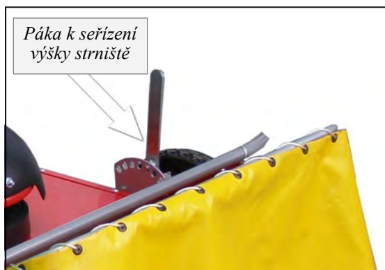
Obr. 28 Páka k seřízení výšky strniště
